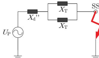
**Abb. 14.1:** Ersatzschaltbild für einen Kurzschluss an der Sammelschiene (SS)
