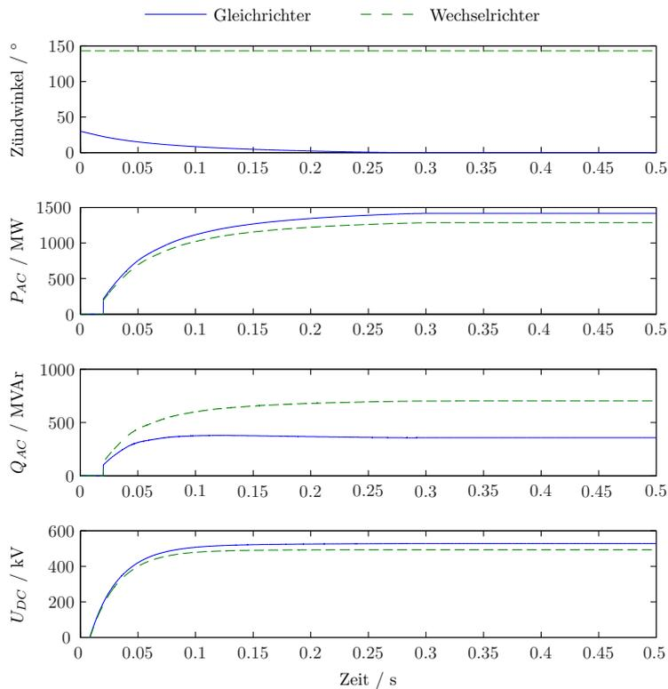
**Abb. 9.6:** Simulationsergebnisse bei Leistungssollwert 1500 MW
