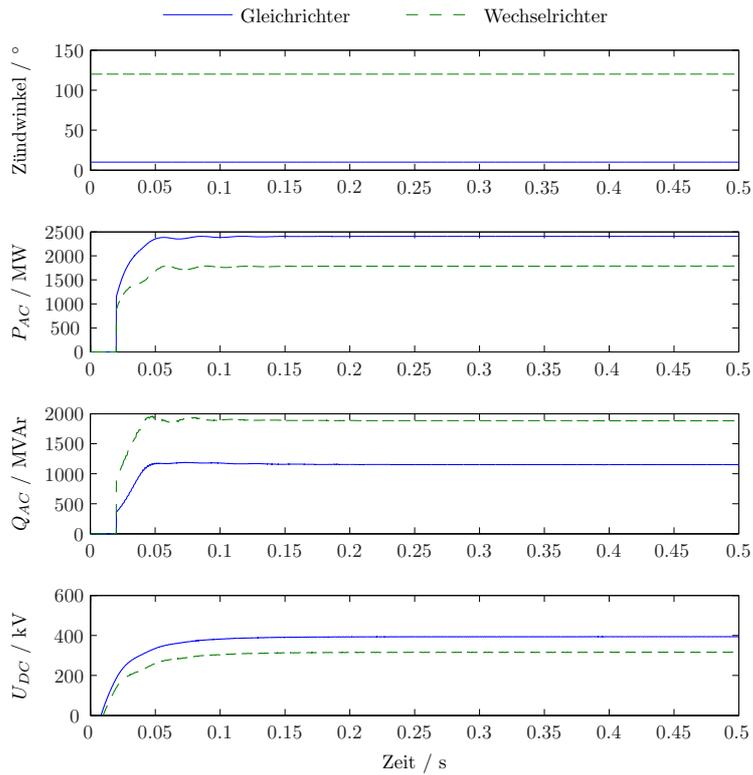
Abb. 9.7: Simulationsergebnisse bei Wechselrichter-Zündwinkel  $120^\circ$
