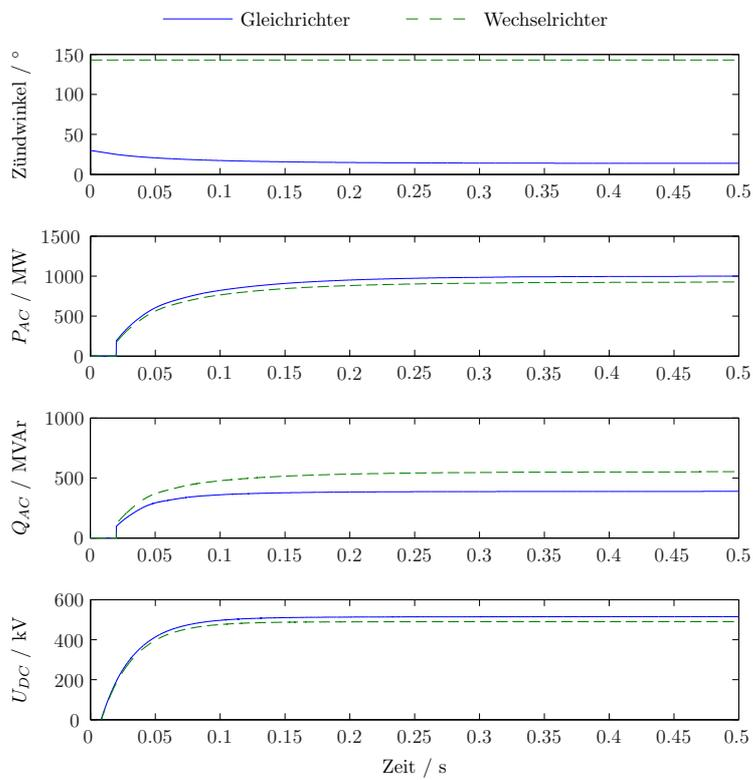
**Abb. 9.5:** Simulationsergebnisse bei Leistungssollwert 1000 MW
