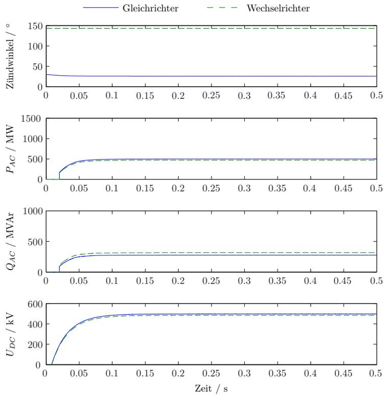
**Abb. 9.4:** Simulationsergebnisse bei Leistungssollwert 500 MW
