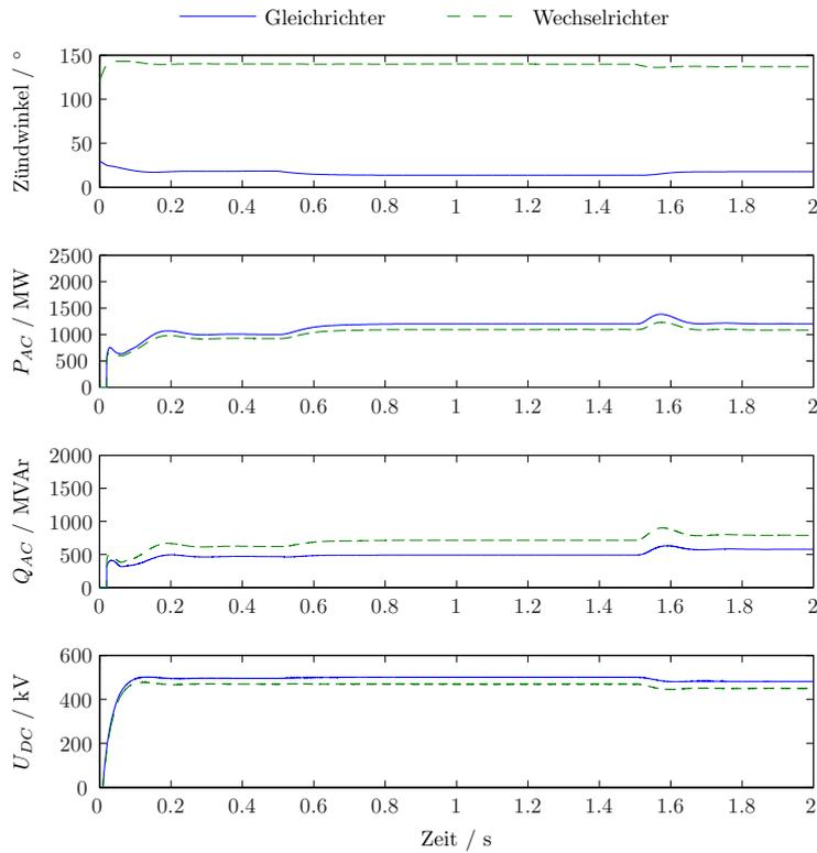
Abb. 9.12: Simulationsergebnisse für die kombinierte Regelung von Leistung und Spannung
