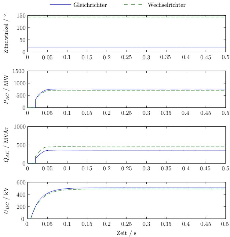
**Abb. 9.2:** Simulationsergebnisse bei Gleichrichter-Zündwinkel  $20^\circ$
