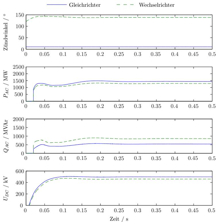
Abb. 9.11: Simulationsergebnisse für Spannungssollwert  $-460 \text{ kV}$
