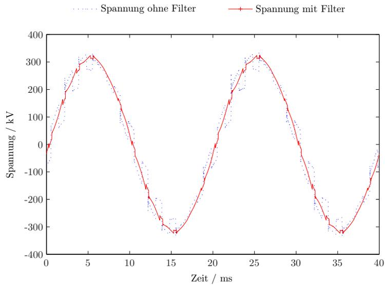
**Abb. 9.14:** Spannungsverlauf in Netz 1, mit und ohne AC-Filter
