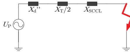
Abb. 14.2: Ersatzschaltbild für einen Kurzschluss im Netz mit SCCL
