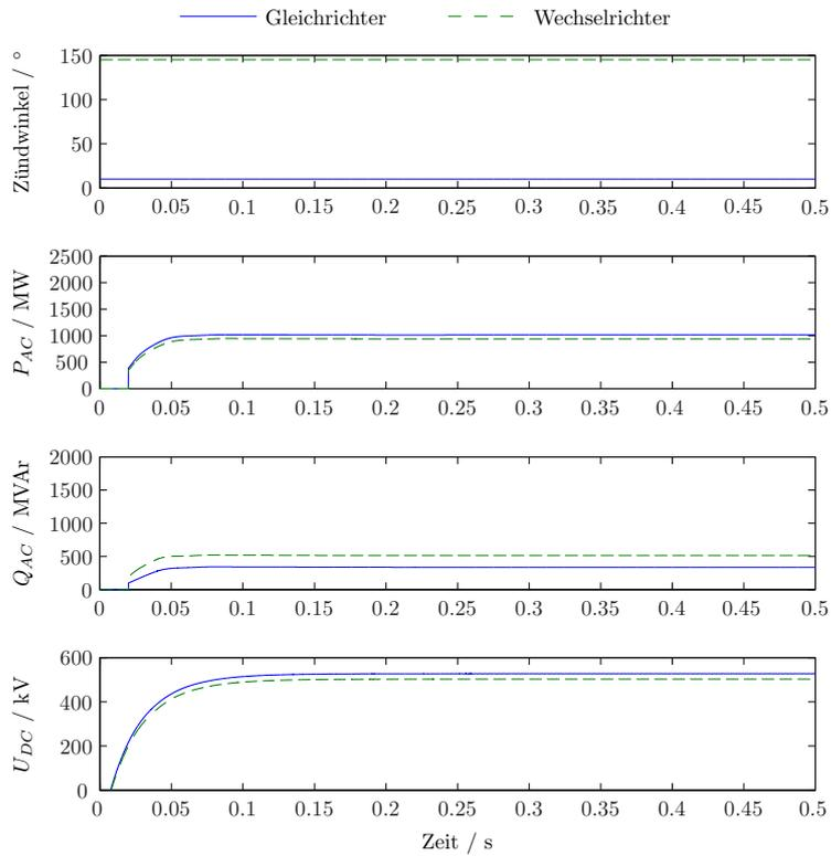
**Abb. 9.9:** Simulationsergebnisse bei Wechselrichter-Zündwinkel  $145^\circ$
