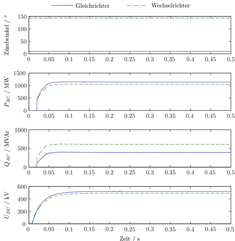
Abb. 9.1: Simulationsergebnisse bei Gleichrichter-Zündwinkel  $10^\circ$
