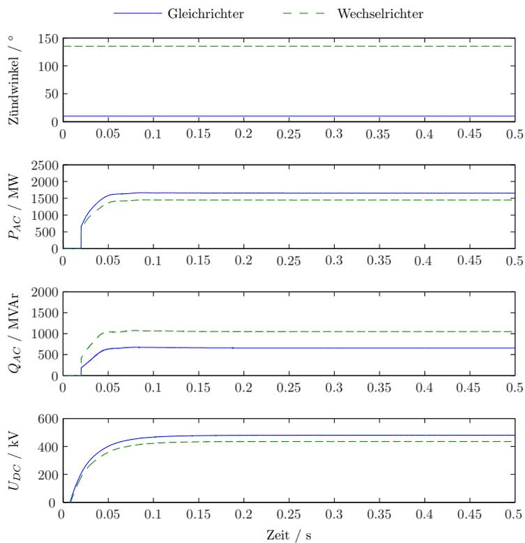
Abb. 9.8: Simulationsergebnisse bei Wechselrichter-Zündwinkel  $135^\circ$
