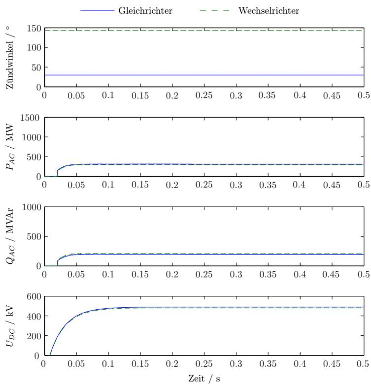
**Abb. 9.3:** Simulationsergebnisse bei Gleichrichter-Zündwinkel  $30^\circ$
