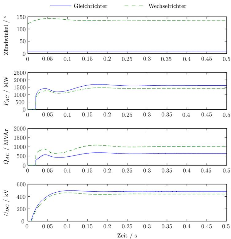
**Abb. 9.10:** Simulationsergebnisse für Spannungssollwert  $-440\text{ kV}$
